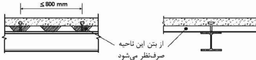
شکل ۸-۸-۲-۱۰: عرشه فولادی که کنگره‌های آن عمود بر محور طولی تیر است
